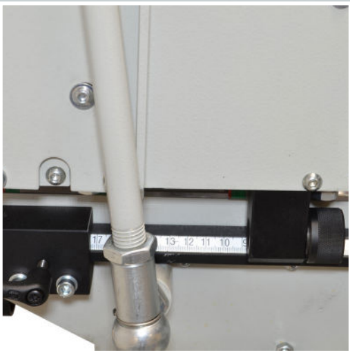
Bohrtiefeeneinstellung, Feineinstellung inklusiv
