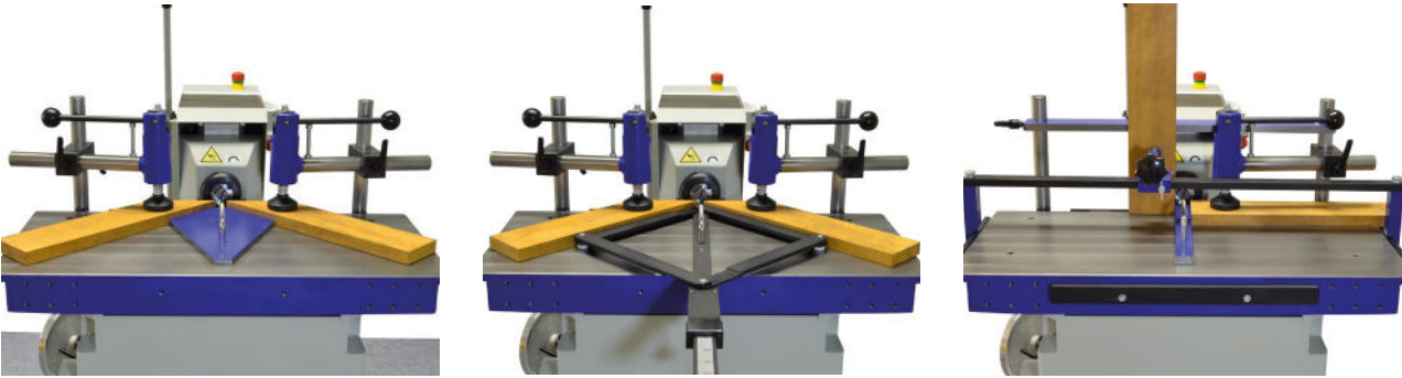
Gehrungsanschlag für Winkel 22,5° und 45° Doppelwinkelverstellanschlag für Winkel von 22,5° bis 75° Spannbrücke zum senkrechten Spannen von Werkstücken
