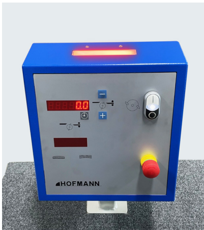
Sicherheitslicht am Pult (leuchtet bei laufender Messerwelle)
