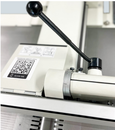
Anschlagverstellung über Einhandbedienung nach Gradanzeige
