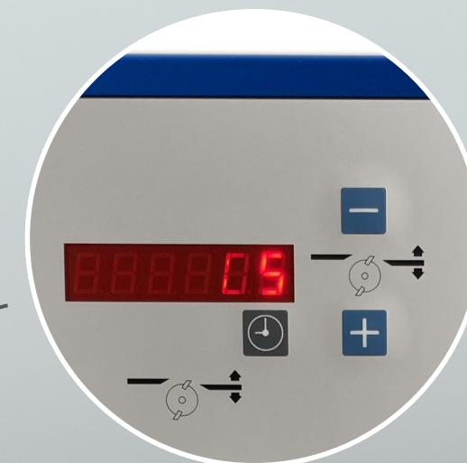
Elektrische Verstellung der Spanabnahme, selbsthemmend
