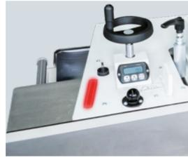
Sicherheitslichtleiste am Fräsanschlag
