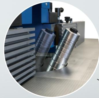
Fräsetiefenverstellung erfolgt über die Spindel
