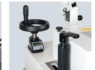
Fränschlag Typ 2601 mit LCD-Anzeige
