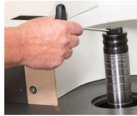
Fräsdorn mit Schnellspannmutter „fix“
