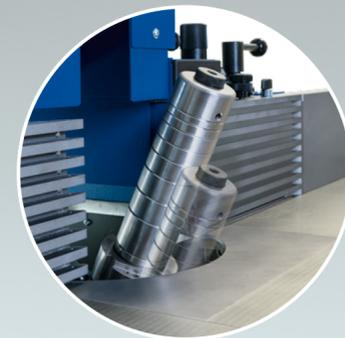
Höhenverstellung erfolgt linear über die Spindel
